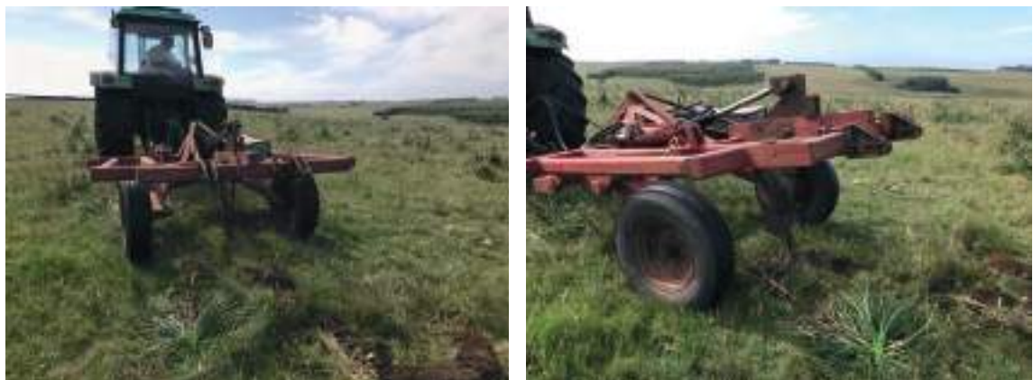
Figura 8. Laboreo en otoño para plantación en primavera, subsolador sobre campo natural mejorado con Lotus Rincón.
