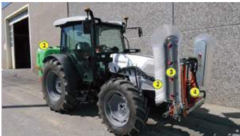
Detalles del aplicador: 1.- Depósito, 2.- Pantallas (Cepillos flexibles que permiten sortear obstáculos y evitan la deriva del producto, se debe pasar entre la línea), tratamiento de dos hileras a la vez, 3.- Boquillas de aspersión de baja deriva, 4.- Cabezal de pulverización.
