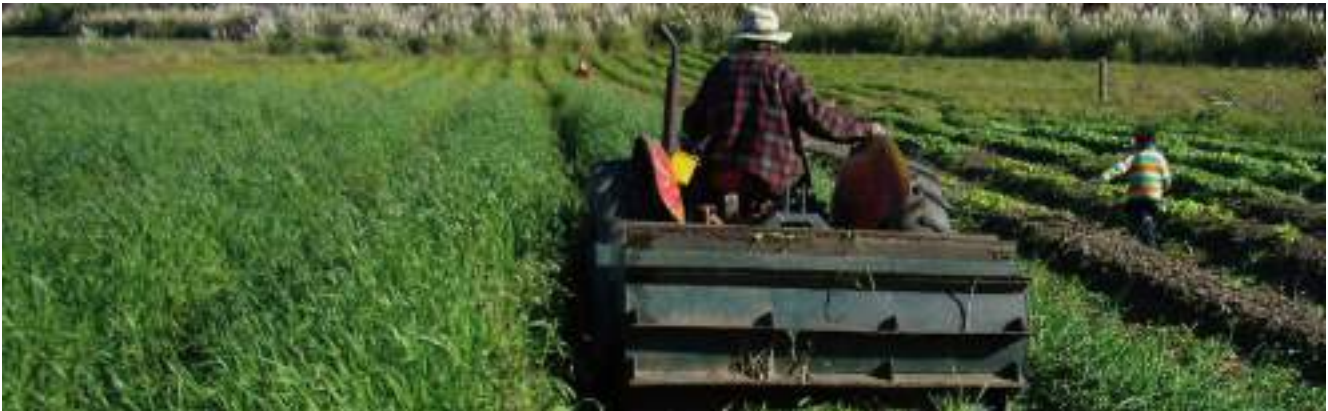
Figura 7: Operación de aplastado de un abono verde vivo, previo a la aplicación de herbicida.
