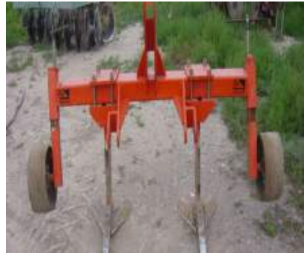
Figura 10. Multiarado de 2 cuerpos, con sus piezas accesorias.
