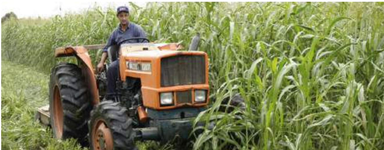
Figura 5: Operación de corte de abono verde con rotativa sobre suelo sin encanterar, antes de incorporarlo al suelo.
